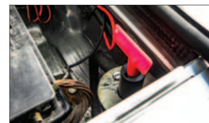
Beter voor de accu: een massaschakelaar
